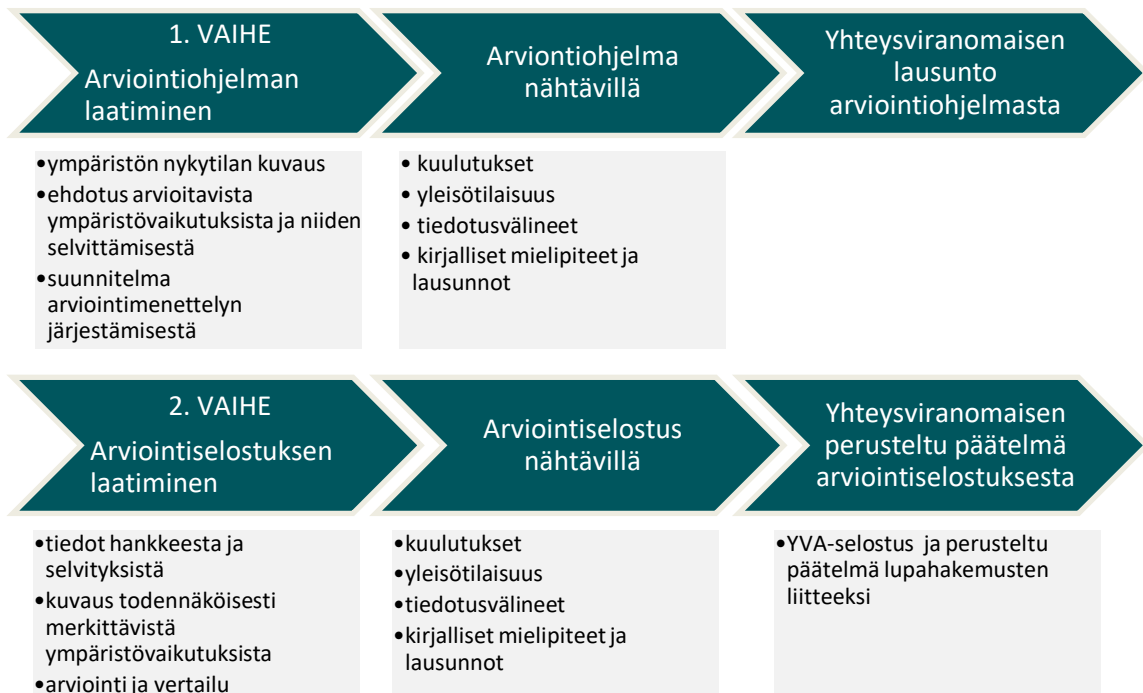
Kuva 2.1. YVA-menettely on kaksivaiheinen prosessi. Ensimmäisessä vaiheessa laaditaan työohjelma laadittavista selvityksistä (YVA-ohjelma). Toisessa vaiheessa laaditaan varsinainen ympäristövaikutusten arviointi (YVA-selostus).
